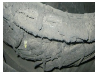
Encrassement typique d'un alternateur exploité en environnement industriel tropical (raffinerie d'huile de palme)
