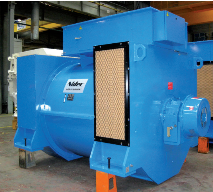
Alternateur LSA 58 destiné à une utilisation en centrale de production équipé de filtres
