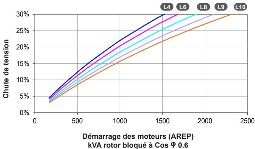
1) Pour un cos  $\Phi$  différent de 0.6, multiplier les kVA par  $K = \sin \Phi / 0.8$
